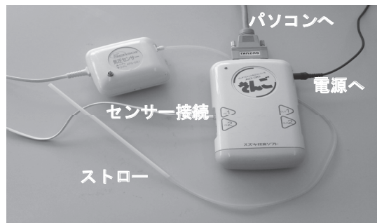
写真 3 周辺機器の組み立て
