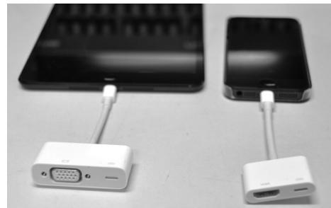
図17 VGA (左) HDMI (右) 各アダプター
