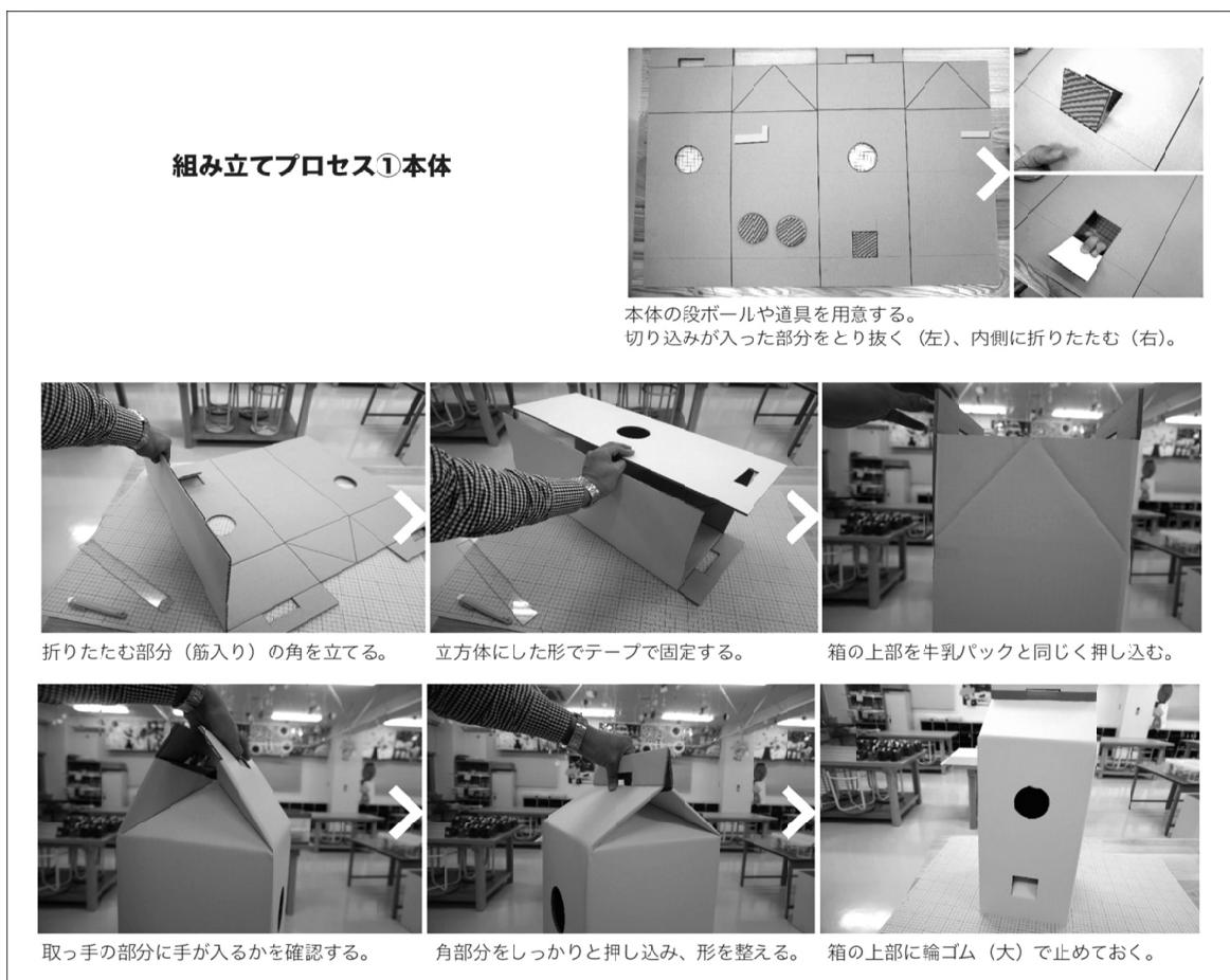
図 5. 組み立てプロセス①本体
